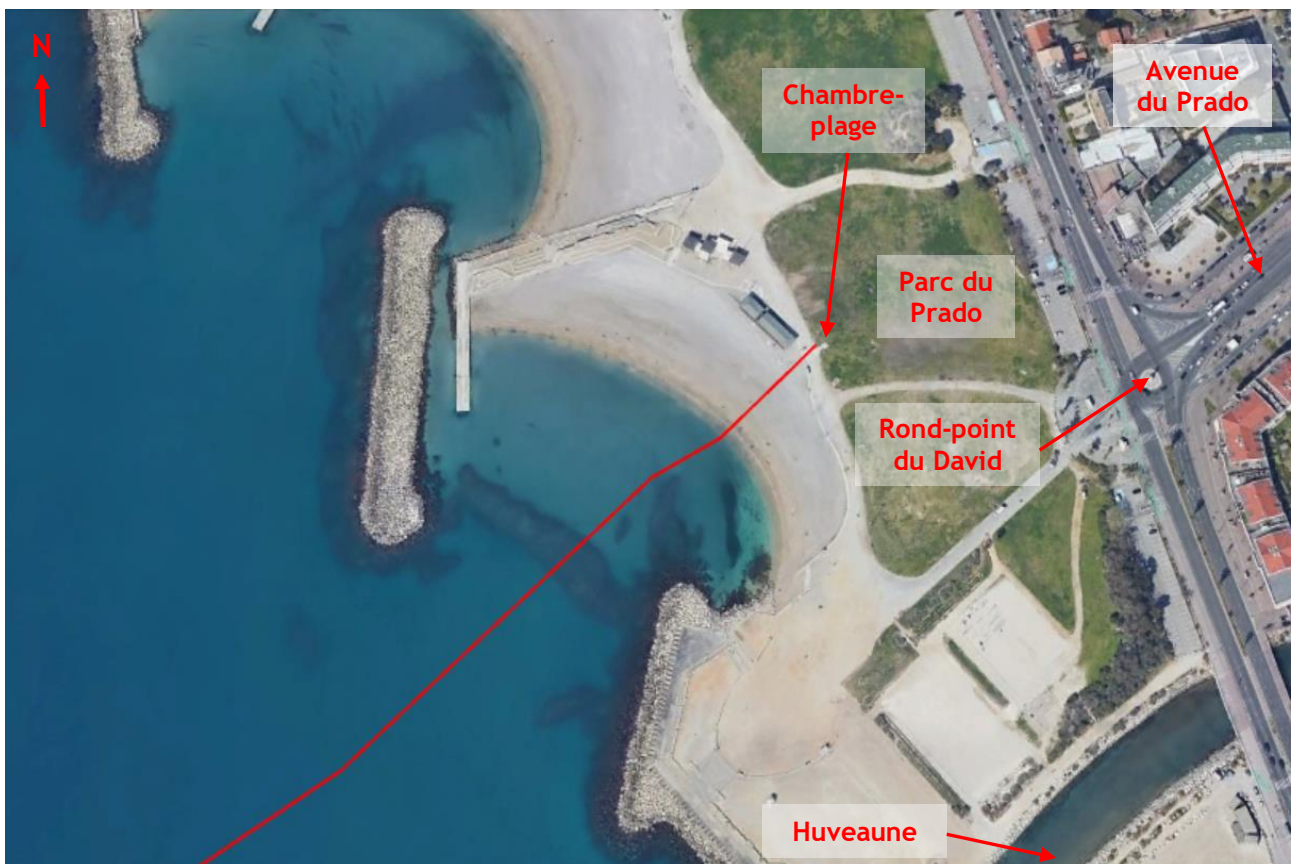
Figure 3 : Site d'implantation du câble PEACE MED et de la chambre-plage existante en limite du parc et de la plage du Prado
